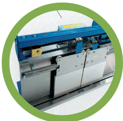
Частотный привод дверей
